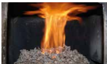
A) Spalanie pelletu z biomasy agro z dodatkiem mineralnym w piecu retortowym – popiół jest sypki, brak spieków
